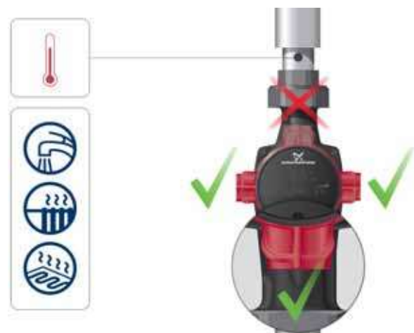
Σχ. 3 Θέσεις κιβωτίου ελέγχου, συστήματα θέρμανσης και συστήματα ζεστού νερού οικιακής χρήσης
